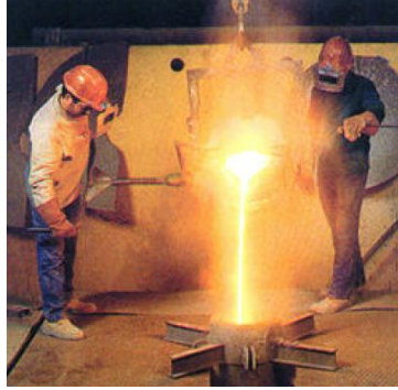
Resim 1.2: Düşey savurma dökümün yapılışı
