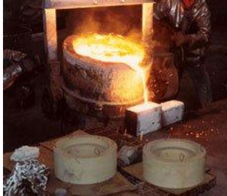
Resim 1.5: Potadan düşey savurma dökümün kalıba dökülmesi
